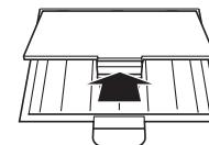
2. Вставить в батарейный отсек шесть батарей типоразмера AA.
